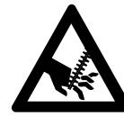
**Не прикасайтесь к режущим ножам** при работающем двигателе. Если режущие ножи блокируются каким-либо предметом, немедленно остановите двигатель и вытяните штексер соединительного кабеля, – лишь после этого устраним посторонний предмет, – **опасность травмы !**
