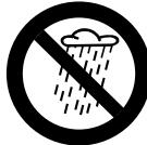
Не работайте мотоустройством во время дождя или в очень влажном окружении, – приводной двигатель не водозащищенный. – Опасность короткого замыкания и удара электрическим током !
