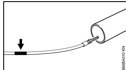
I änden på rengöringsslängen finns en markering (se pilen):
