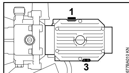
Primul schimb de ulei se face după 50 ore de funcționare, celelalte schimburi ale uleiului se fac o dată la șase luni sau la câte 500 ore de funcționare.
