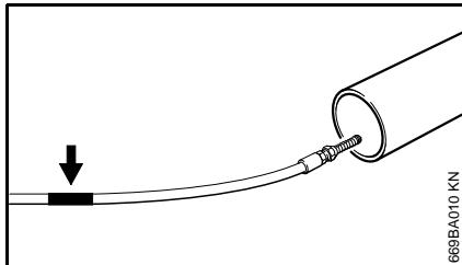
Un marquage (flèche) se trouve à l'extrémité du tuyau de nettoyage :
