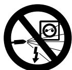
Älä suuntaa vesi- suihku- sähkökalusteisiin, liittimiin äläkä sähköjohtoihin. Oikosulun vaara!
