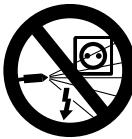
Ne jamais nettoyer des installations électriques, des raccords électriques ou des câbles sous tension avec le jet haute pression ou le tuyau d'eau – **risque de court-circuit !**
