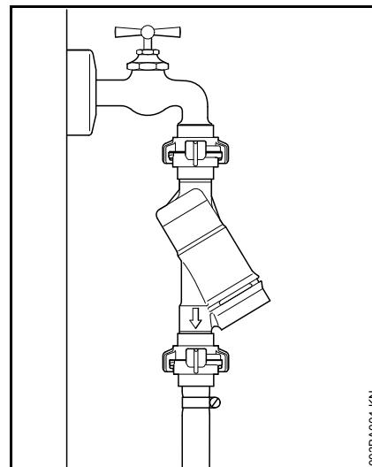
Pour le raccordement au réseau d'eau potable, il faut intercaler entre le robinet d'eau et le flexible un clapet de non-retour conforme à la norme IEC/EN 60335-2-79.
