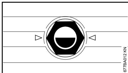
Contrôler tous les mois le niveau d'eau de la pompe à haute pression et de l'engrenage (seulement sur RB 402 PLUS).
