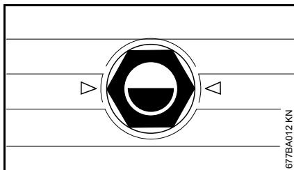
Nivelul de ulei al pompei de înaltă presiune și mecanismului (numai la RB 402 PLUS) se controlează lunar.
