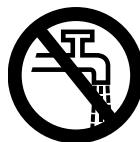
Ne pas brancher le nettoyeur haute pression directement sur le réseau de distribution d'eau potable.
