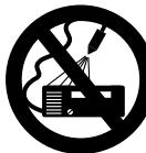
Ne jamais nettoyer des machines ou appareils électriques avec le jet haute pression ou le tuyau d'eau – **risque de court-circuit !**
