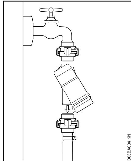
La racordarea la rețeaua de apă potabilă între robinetul de apă și furtun trebuie să fie instalată o supapă de return conform IEC/EN 60335-2-79.
