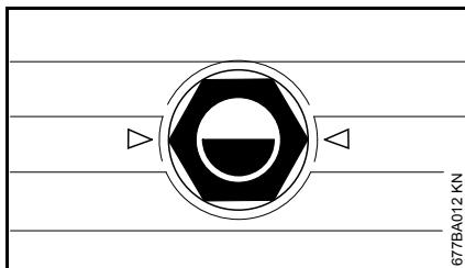
Уровень масла высоконапорного насоса и передачи (только у RB 402 PLUS) проверять ежемесечно.
