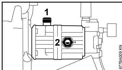
Primul schimb de ulei se face după 50 ore de funcționare, celelalte schimburi ale uleiului se fac o dată la șase luni sau la câte 200 ore de funcționare.
