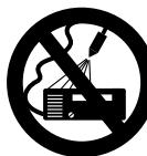
Nu stropiți cu jetul de înaltă presiune sau cu furtunul cu apă electroutilaje – **pericol de scurtcircuitare!**
