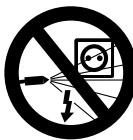
Nu stropiți cu jetul de înaltă presiune sau cu furtunul cu apă aparatele electrice, racordurile și cablurile străbătute de curent – **pericol de scurtcircuitare!**
