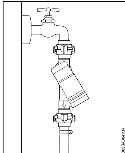
При подсоединении к сети снабжения питьевой водой между водопроводным краном и шлангом должен монтироваться возвратный клапан согласно IEC/EN 60335-2-79.
