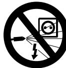
Электрооборудование, соединения и токопроводящие провода не обрызгивать не обрызгивать струей из высоконапорного или водяного шланга – опасность короткого замыкания!
