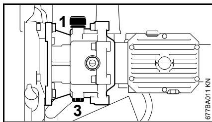
Primul schimb de ulei se face după **50** ore de funcționare, celelalte schimburi ale uleiului se fac o dată la **sase luni sau la câte 500** ore de funcționare.
