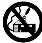
Ни в коем случае не направлять высоконапорную струю или водяной шланг на электрооборудование – опасность короткого замыкания!
